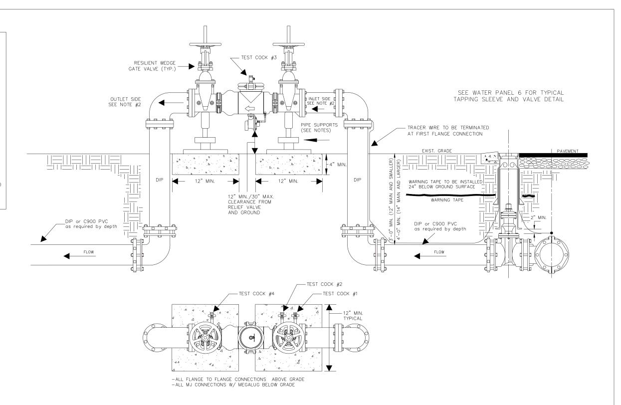
TYPICAL FIRE LINE REDUCED PRESSURE ASSEMBLY
